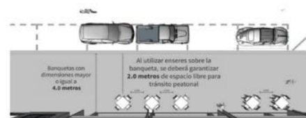
Figura 2. Colocación de enseres en banquetas con un ancho igual o mayor a 4.0 metros
