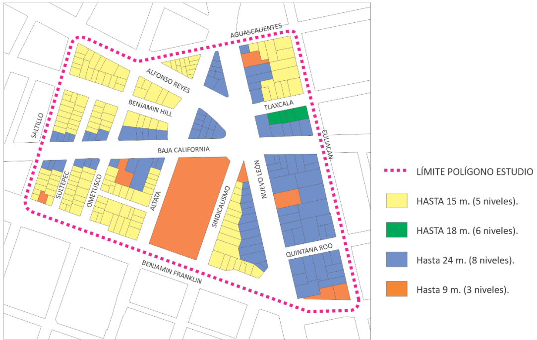
Ilustración 6. Alturas permitidas. Fuente: Programa Parcial de Desarrollo Urbano Hipódromo y con apoyo de la cartografía digital de la Tesorería del Distrito Federal.
